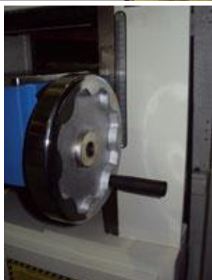
Подъем/опускание рабочего стола при помощи маховика. Отображение размера на линейке.
