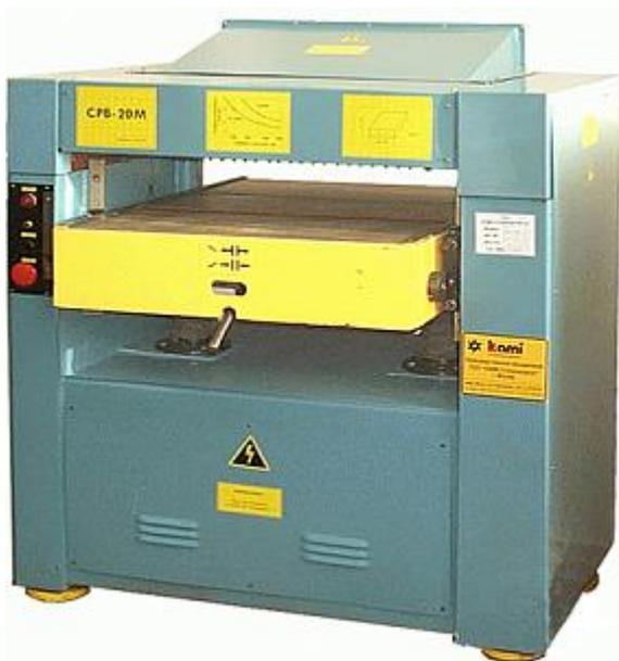
Станки предназначены для плоскостного строгания досок, брусков, щитов в заданный размер по толщине.
