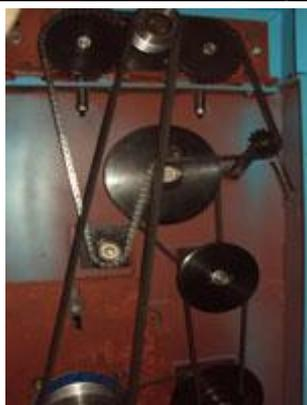
Привод ножевого вала от двигателя мощностью 4 кВт через клиноременную передачу. Привод вальцов подачи-цепной.
