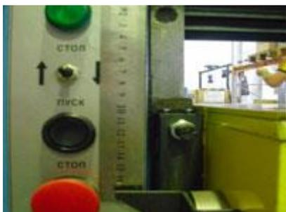
Выставление размера при по линейке. Электроподъем стола.
