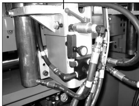
Датчик крайнего положения подвижных тисков
