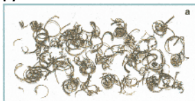
Очень мелкая, пылевидная стружка - подача должна быть увеличена
