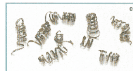
Свободно намотанная (витая) стружка - идеальные условия резания
