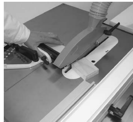
А.3. Поперечный распил при помощи упора
