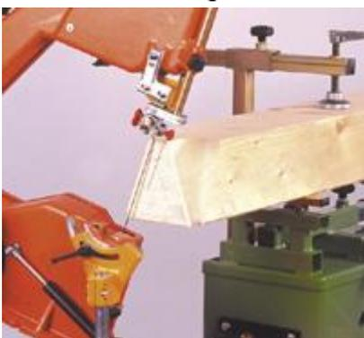
Наклон пильного узла
