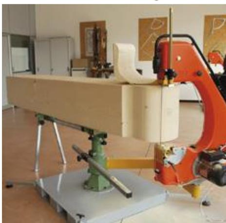
Шарнирный механизм закрепленный на центральной колонне - разнообразное криволинейное пиление
