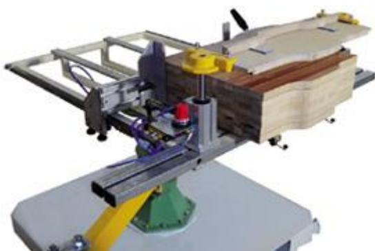
Устройство для крепления пакета заготовок, например мебельного щита
