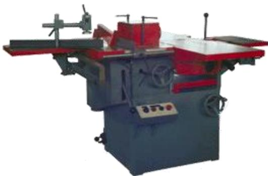
Комбинированный деревообрабатывающий станок предназначен для комплексной обработки столярных изделий и несложной мебели на предприятиях средней мощности.
