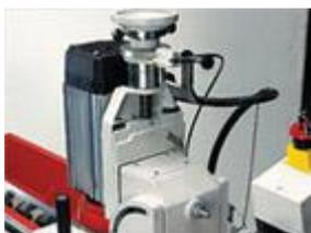
Позволяет в автоматическом режиме затачивать ножи. При этом не требуется постоянное присутствие заточника, исключается влияние человеческого фактора и повышается качество заточенных ножей.
