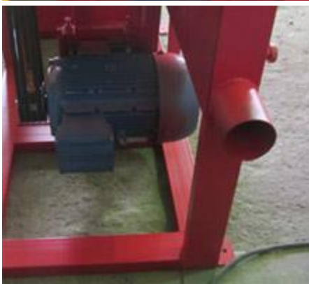
На станке предусмотрен аспирационный патрубок для удаления продуктов резания
