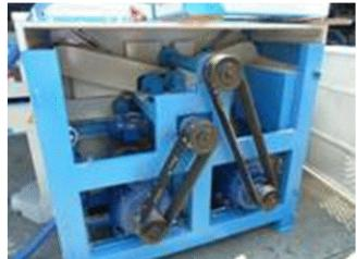
Привод валов обеспечивает надежная ременная передача. Диаметры валов 70 мм. Они выполнены из поверхностно упрочненной стали, прошедшей термообработку, установлены на пылезащищенных подшипниках высокого класса точности. Благодаря этому достигается высокий ресурс агрегатов.
