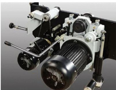
Пильный узел литой, обладает прекрасными виброгасящими свойствами, обеспечивая идеальное качество распила и долговечность подшипников. Станок оснащен раздельными приводами на основную и подрезную пилы с возможностью смены частоты вращения вала основной пилы.
