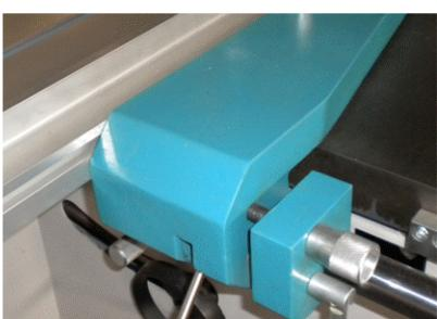
Механизм микрометрической настройки значительно устанавливает параллельного упора. Регулировочный винт обеспечивает юстировку размера с точностью до миллиметра.
