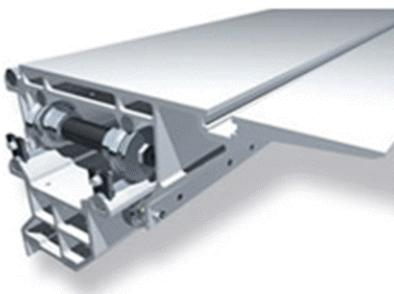
Роликовая каретка с цилиндрическими направляющими действует по принципу «вагонной тележки», обеспечивая, помимо, точности и качества распила, долговечность работы. Практика основных производителей показывает что на сегодняшний день такой тип каретки наиболее надежен, долговечен и практически не требует технического обслуживания.
