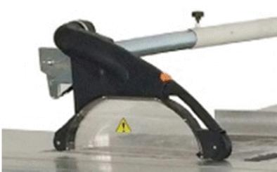
Большой аспирационный кожух с роликами качения легко настраивается по толщине заготовки, обеспечивая качественное пылеудаление, а также гарантирует полную защиту оператора. Такая конструкция позволяет исключить из раскroя расклинивающий нож без снятия защитного кожуха.
