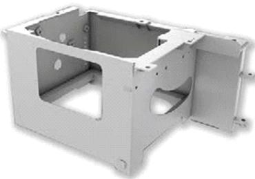
Станина станка сварная, имеет жесткую пространственную конструкцию, а также обладает значительной массой, достаточной для обеспечения точности раскroя и долговечности работы станка. Станина проходит процесс отжига для снятия внутренних напряжений в сварных швах.
