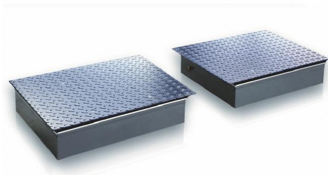
Пневматический люфт детектор (тестер люфтов) подвески. Беспроводная версия. Две испытательные площадки. Поперечное и поворотное движение платформ имитирует все возможные нагрузки. Управление при помощи кнопок на тестовом фонаре с радиоканалом. Позволяет визуально определить люфты в сочленениях рулевого привода и подвески. Нагрузка на ось а/м до 4т. Производство: UNIMETAL (Польша).
