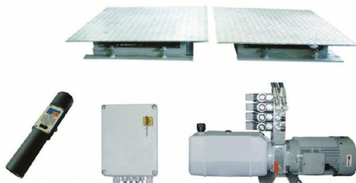
Гидравлический тестер люфтов подвески (люфт-детектор). Беспроводная версия. Две испытательные площадки, гидравлически перемещаемые в 8 направлениях при помощи кнопок на тестовом фонаре с радиоканалом. Позволяет визуально определить люфты в сочленениях рулевого управления и подвески. Нагрузка на ось а/м до 20 т. Производство: Cartec (Германия).
